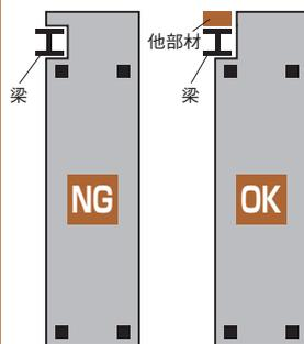
⑤左右の留め付け部の高さを合わせる。
