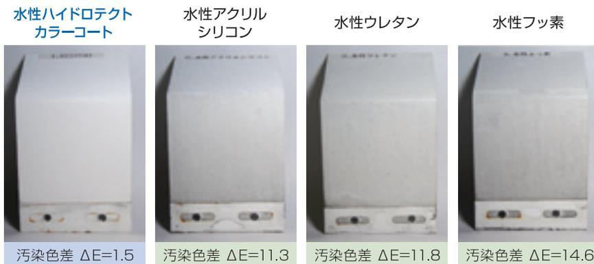
汚染負荷の高い塗料工場敷地内で試験を行った為、一般塗料は低汚染型にも関わらず、かなり汚れておりますが、光触媒塗料は、極めて少ない汚染状況です。
