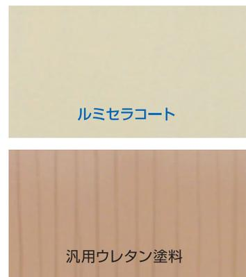
勾配屋根を設け、雨筋汚れのつきにくさを比較しました。汎用ウレタン塗装品に比べルミセラコートは、ほとんど雨筋汚れが目立ちません。
